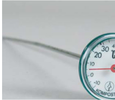
Figura 6. Termómetro de compostagem (Fonte: Projecto de Compostagem no Seixal - O seu Guia de Compostagem, 2003)
